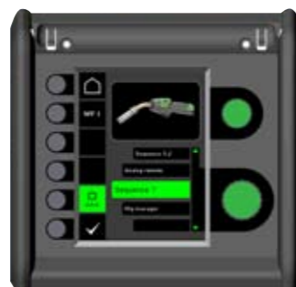
Wybór palnika w głównym menu; Galaxy obsługuje wszelkie funkcjonalności palników MIG-A Twist.
