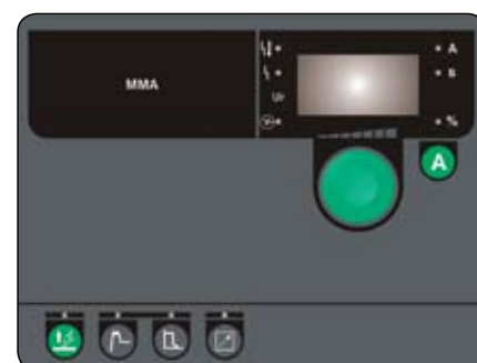
Pi MMA Panel sterowania MMA z opcją procesu TIG z prostym zajarzeniem LIFTIG®
